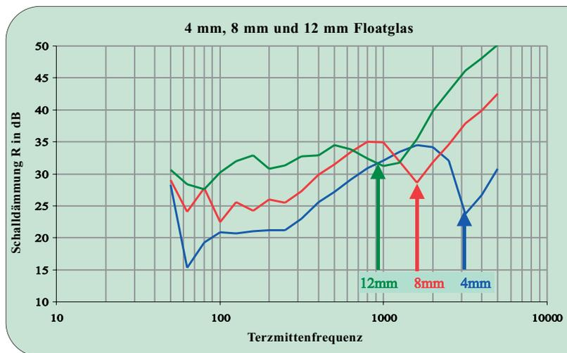
Abb. 6: Einfluss der Scheibendicke auf die Koinzidenzfrequenz
