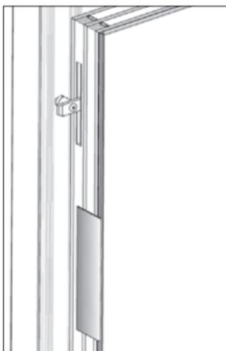
vetroFit SG ist ein fertig konfektioniertes Isolierglassystem für Structural-Glazing (SG)-Fassaden. Die Besonderheit ist hier die mechanische Sicherung der Gläser, die in Deutschland ab 8m Einbauhöhe bauordnungsrechtlich vorgeschrieben ist. Bei vetroFit SG wird sie über eine Nut im Glas und eine patentierte, mechanisch entkoppelte und von außen nahezu unsichtbare Sicherungsfeder realisiert.
